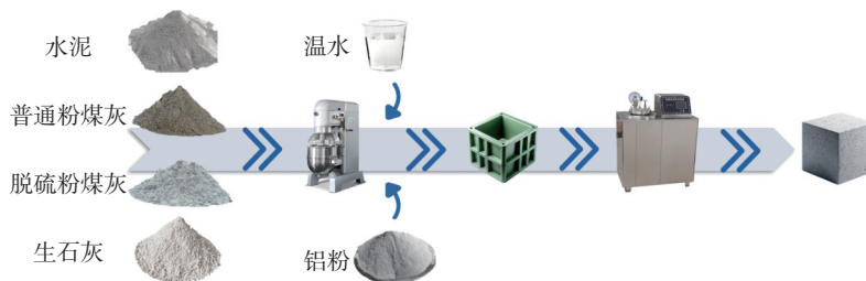
图 2 试件制备过程
